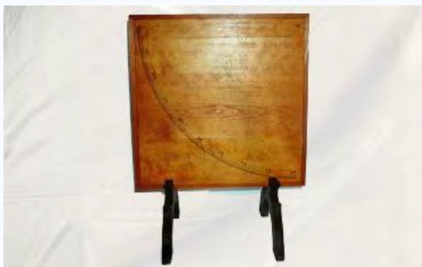
Ryc. 1. Kwadrant słoneczny: używany w pomiarach wysokości słońca i inklinacji (nachylenia) ekliptyki – orbity Ziemi – w stosunku do równika niebieskiego.
