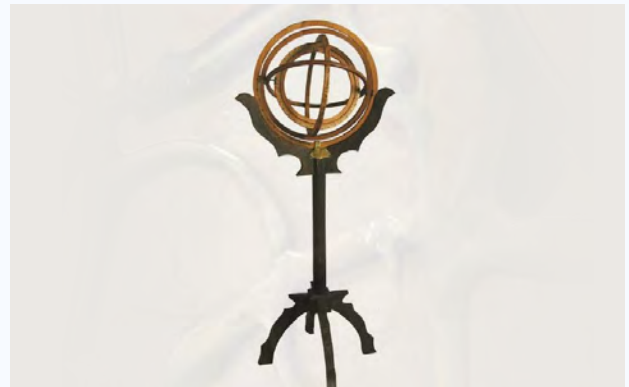
Abb. 3 Sphärisches Astrolabium: das fortschrittlichste astronomische Instrument der Antike, verwendet zur Bestimmung der ekliptischen und äquatorialen Koordinaten von Himmelskörpern.
