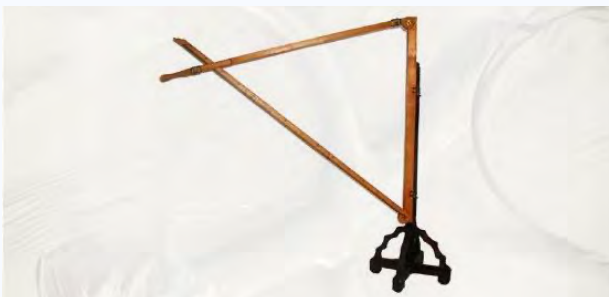
Abb. 2 Parallaktischer Linealstab oder Triquetrum: ein Instrument zur Messung der astronomischen Höhe der Sonne (der scheinbaren Veränderung ihrer Position infolge der Bewegung der beobachtenden Person auf der Erde).
