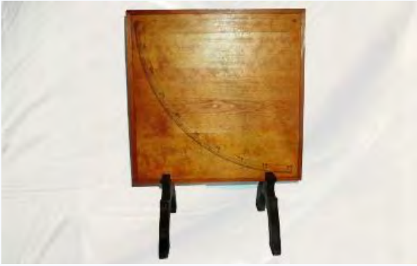
Abb. 1 Sonnenquadrant: verwendet zur Messung der Sonnenhöhe und der Inklination (Neigung) der Ekliptik – der Erdbahn – gegenüber dem Himmelsäquator.
