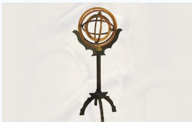
Ryc. 3. Astrolabium sferyczne: najbardziej zaawansowany instrument astronomiczny starożytności wykorzystywany do określania ekliptycznych i równikowych współrzędnych ciał niebieskich.
