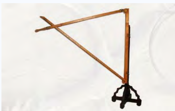
Ryc. 2. Linijka paralaktyczna lub triquetrum: przyrząd stosowany w pomiarach wysokości astronomicznej Słońca (pozornej zmianie jego pozycji w wyniku ruchu osoby prowadzącej obserwację z Ziemi).
